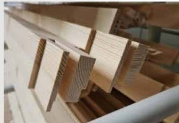
Die Schlitz-Zapfen-Eckverbindung hat bei Fensterbau Schneider Tradition und wird nach wie vor erfolgreich eingesetzt.
