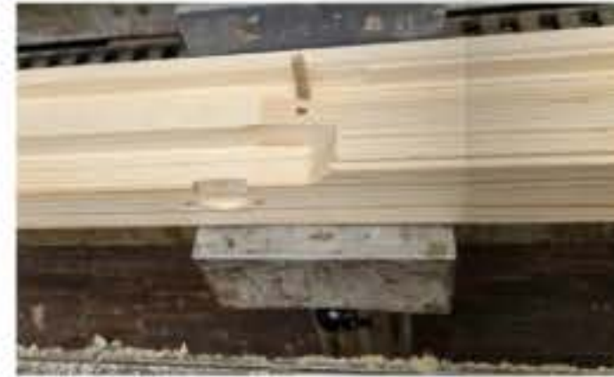
Sonderfräsungen, wie dieser Wechselkopf, sind für die neue CNC-Anlage und die Oertli-Werkzeuge kein Problem.
