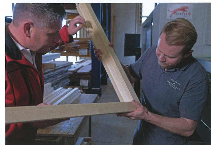
Passt perfekt: Oertli-Fensterspezialist Martin Bauer (li.) und Maximilian Fercher setzen die Schlitz-Zapfen-Verbindung zusammen
