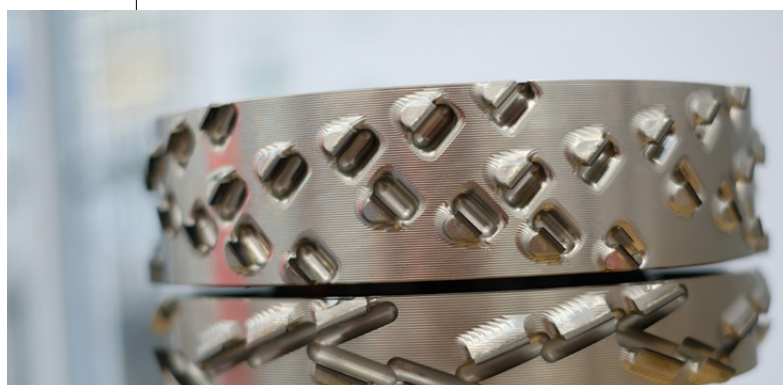
SPLITWERKZEUG: Vorzerspannung mit flachem (oben) und Feinschnitt mit steilem Schneidwinkel (unten)
