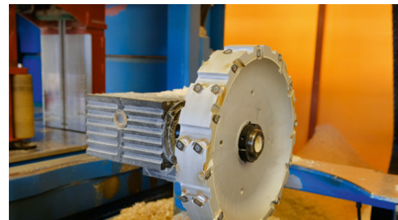
Castor Optimo: Geringerer Schnittdruck ermöglicht bei gleichem Vorschub mehr Zerspanungsleistung
