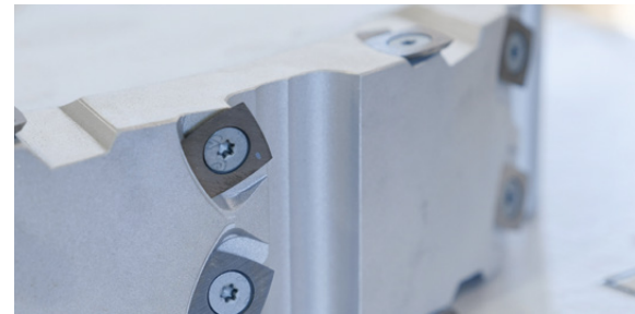
Kervenfräser: Die Schneiden sind am Umfang auf mehrere Spiralen verteilt
