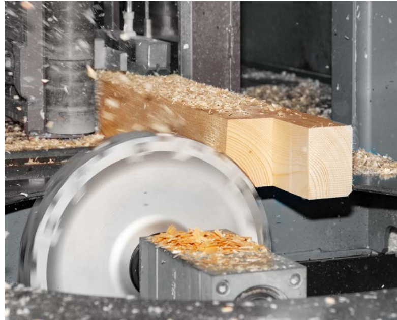
Type S4 : Feuillure avec araseur sur un côté
